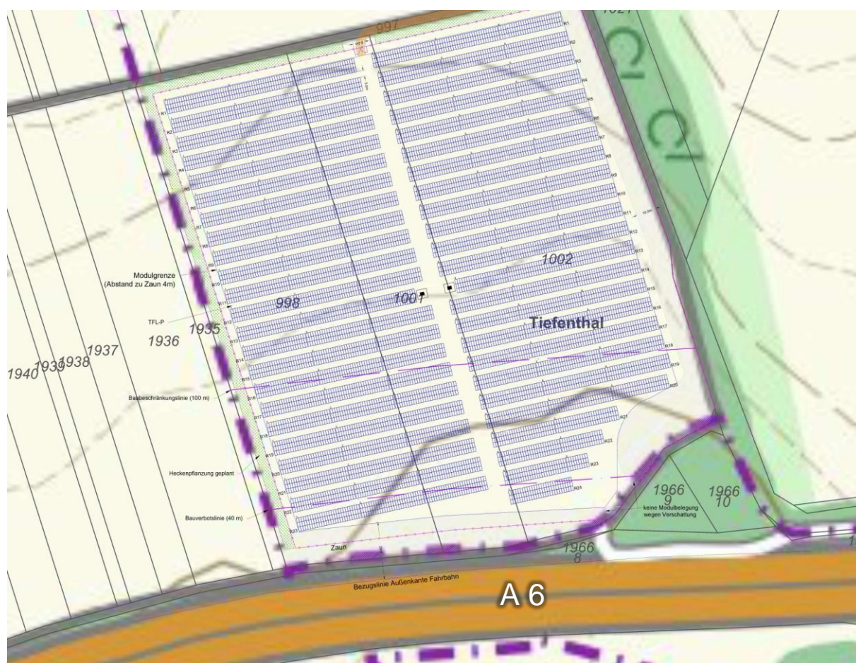
Abbildung 1: Anlagenlayout – Quelle: Auftraggeber
