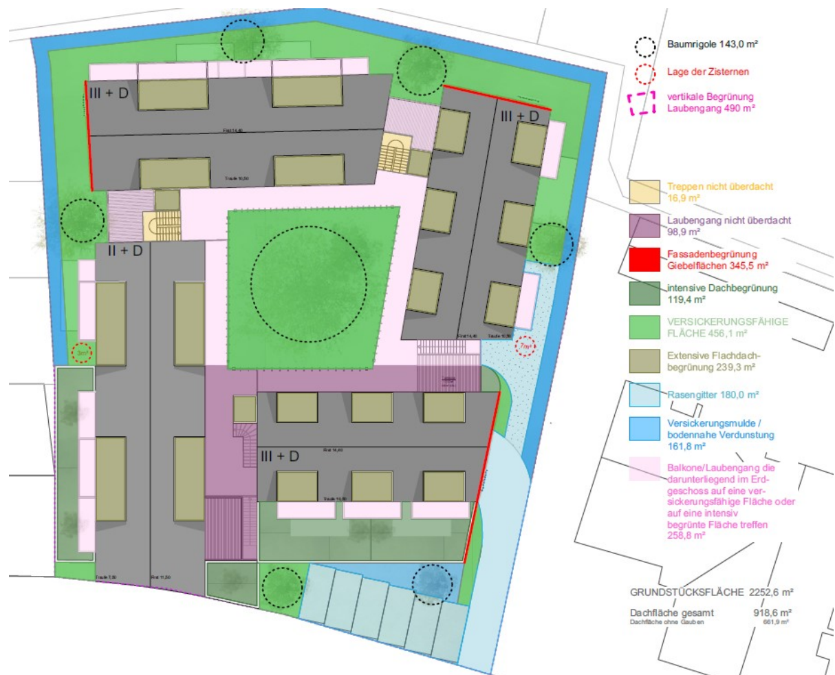
Abbildung 4: Darstellung der Teilflächen im Plangebiet mit Maßnahmen
